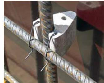
**Abstandhalter AK-Q mit Querklammer** bietet sicheren Halt am Kreuzungspunkt von senkrechter Bewehrung durch eine 2 mm starke Stahlklammer und die vorgegebene Hohlkehle.
