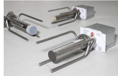
Der trittschallgedämmte Querkraftanschluss Egcopal entkoppelt Bauteile zur Trittschallminderung. Er wird eingesetzt für die Auflagerung von Treppenpodesten, Laubengängen und vorgeständerten Balkonen und überträgt die in der Anschlussfuge wirkenden Querkräfte. Gleichzeitig sorgt die akustisch entkoppelte Auflagerung dafür, dass die Übertragung störender Geräusche in angrenzende Räume gedämmt wird.
