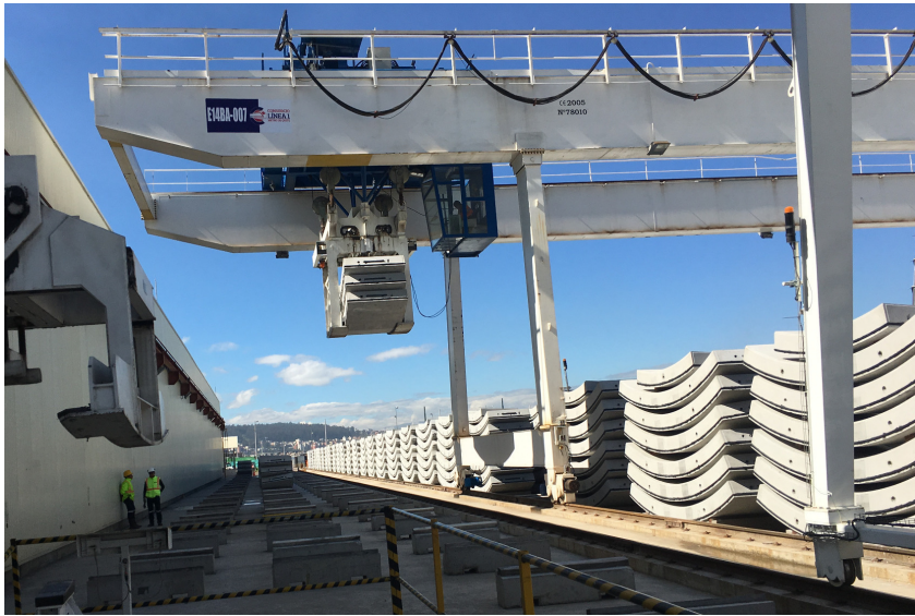
Transport von Tübbingern im Werk © www.maxfrank.com
